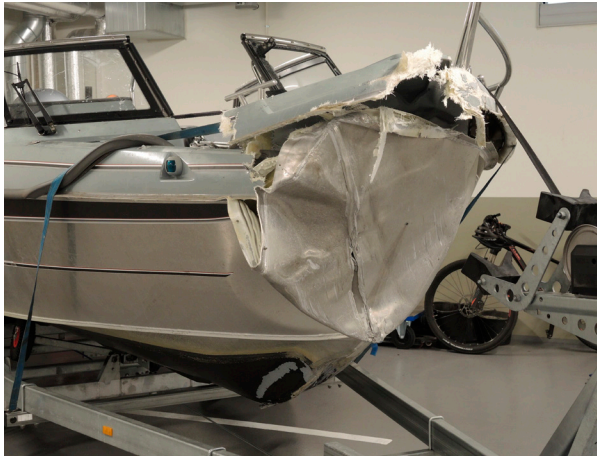
Fritidsbåtens skader i baugpartiet etter kollisjonen. Foto: SHK
