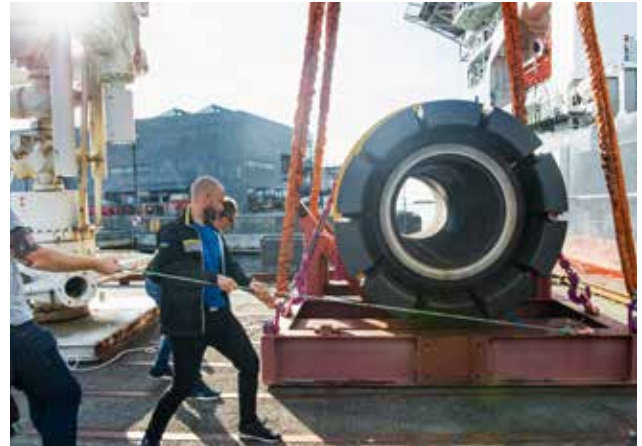
Det var ikke bare sveisehabitatet som kom seilende. En mekanisk rørkobler kom med samme forsendelse. Den brukes til å koble sammen rør på havbunnen, på samme måte som en hageslange kobles til kranen. Rørkobleren er brukt til Troll Fase 3-utbyggingen som stod ferdig i 2021.
