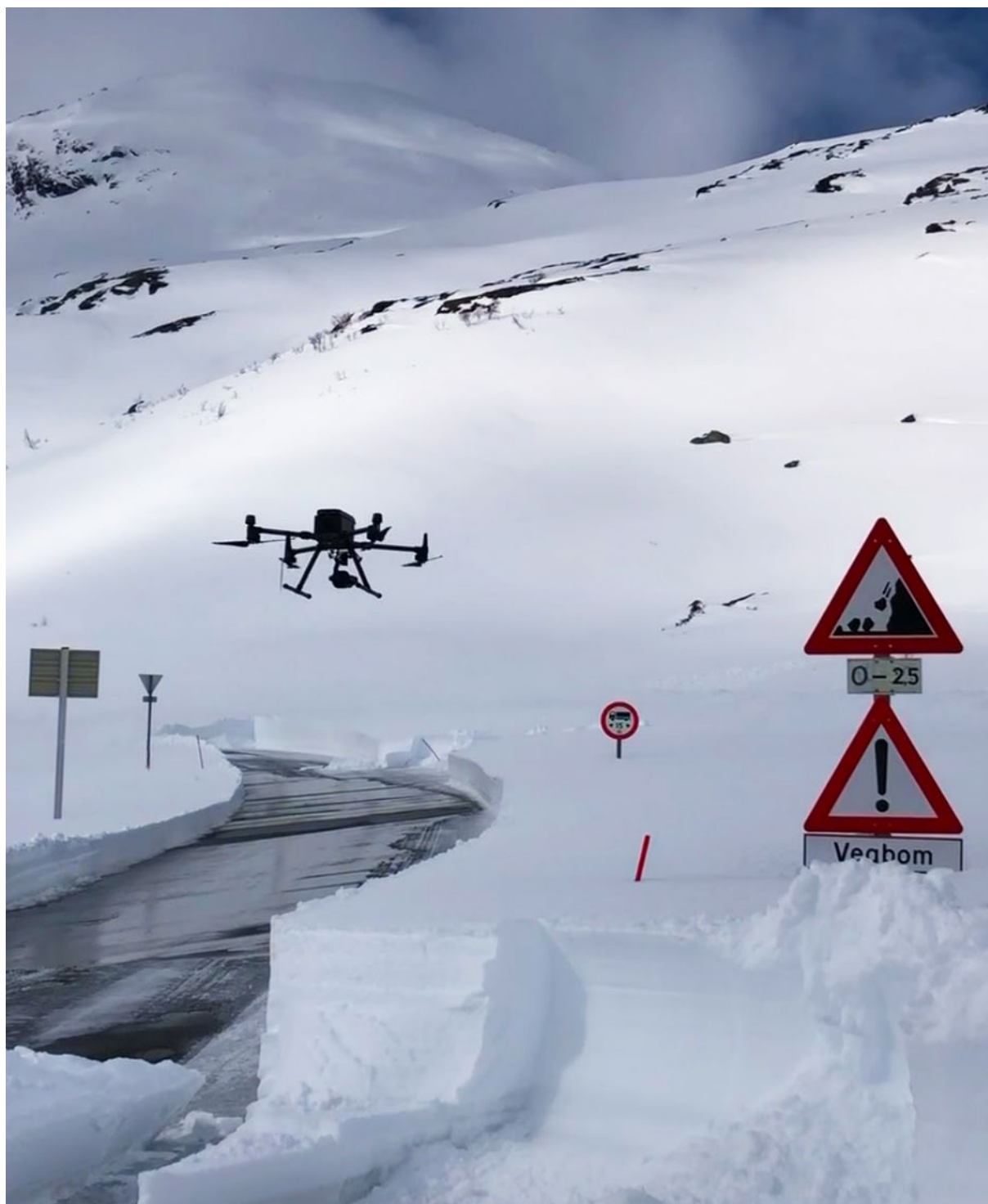
Instrumenterte droner skal gi raskere og bedre grunnlag for å vurdere skredfare. Foto: Tore Humstad / Statens vegvesen
