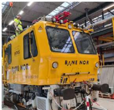
Raymond Lysaker monterer takantenne i forbindelse med ERTMS-prosjektet
