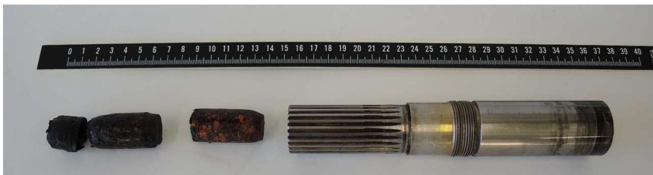
Den inngåande akseltappen etter at enden med brotflata var kutta av. Til venstre to vinkorkar. Den venstre av dei har gått delvis i oppløysing og delt seg i to bitar. Foto: SHK
