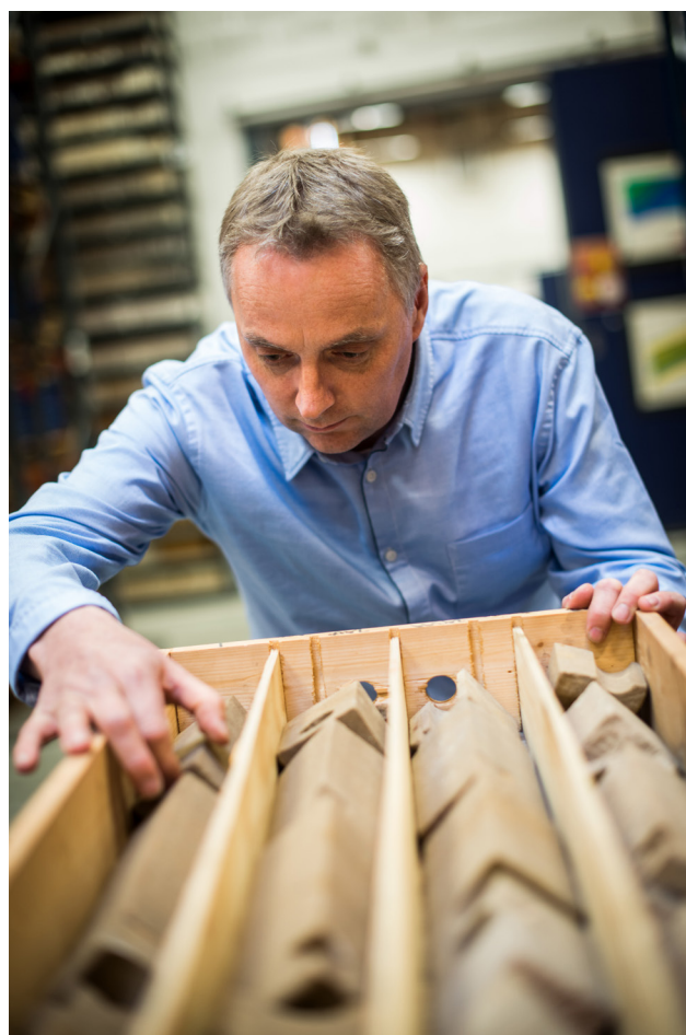
Kjerneprøver i ODs Geobank Samtlige selskaper som skal bore en letebrønn på norsk sokkel er pliktige til å levere en andel av alle borekjerner og borekaks som blir hentet opp. Dette er en viktig del av datainnsamlingen på norsk sokkel.
