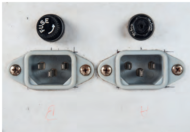
Bilde av detalj etter behandling. Bildet viser streker tegnet på med blyant i forbindelse med produksjon. Bokstaver i rødt er sannsynligvis skrevet på for hånd på et senere tidspunkt. Slike detaljer kan observeres flere steder når man kommer tett på utstyret. Foto: Kirsten T. Hetland/Norsk Oljemuseum
