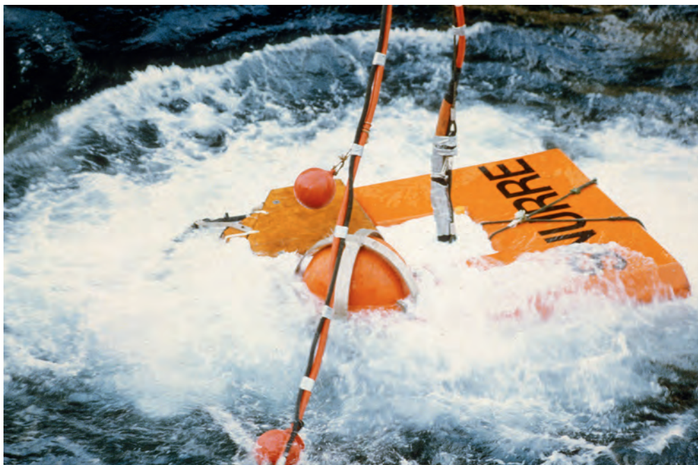
Snurre II i havflaten i forbindelse med arbeid på Friggfeltet. Fjernstyrte farkoster som Snurre kunne brukes i stedet for dykkere ved behov for arbeid på store dyp. Foto: Ukjent/Norsk Oljemuseum
