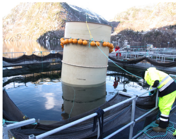
Dyrevelferd: Ny teknologi må testes slik at vi får kunnskap om hvordan dyrevelferden innen havbruk kan bli bedre. Vi har blant annet forsket på snorkelmerder, der merden er nedsenket og fisken får tilgang til luft via en snorkel. Foto: Samantha Bui/HI.
