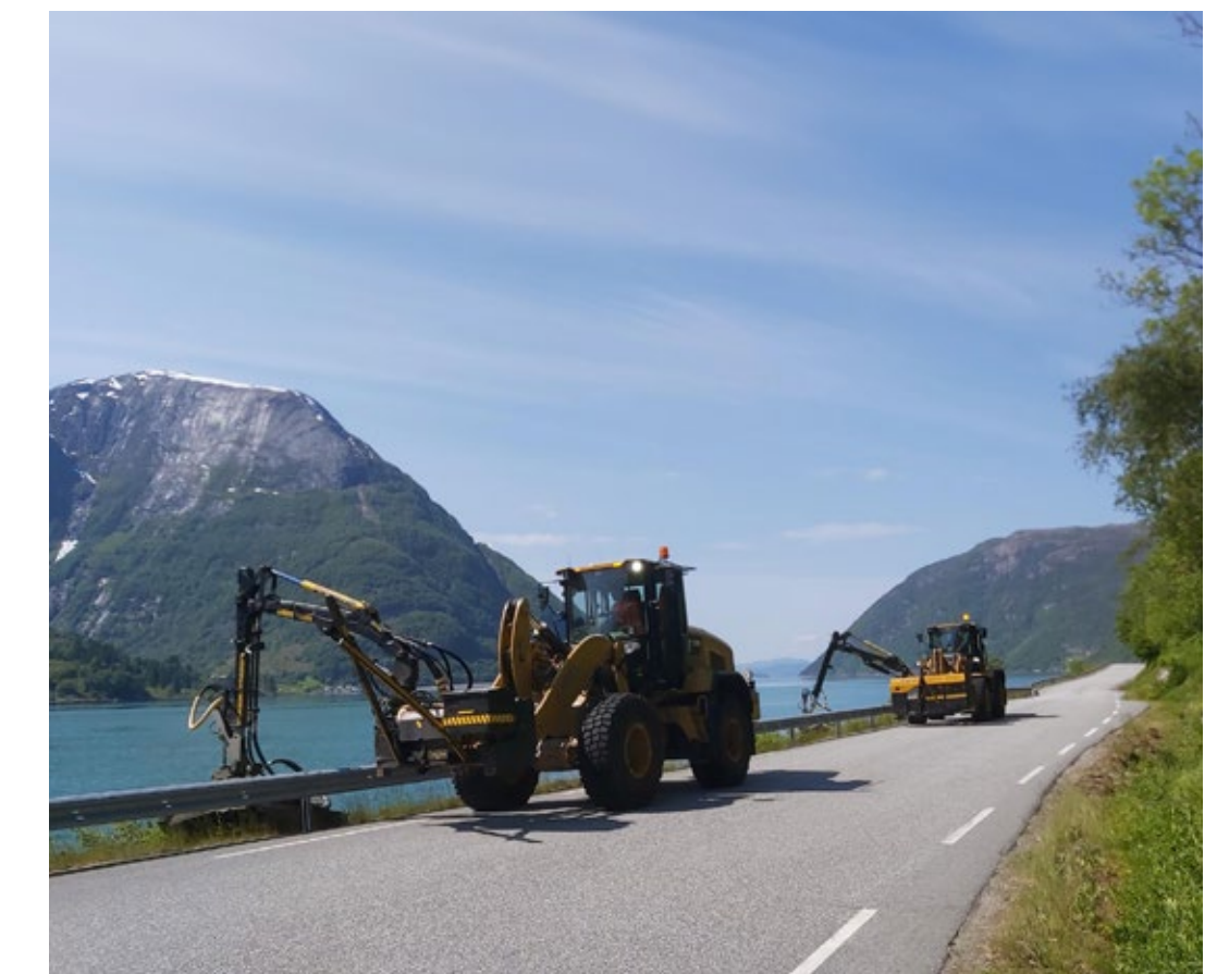
Kantslått i Hardanger. Takket være vårt nye digitale driftssystem får sjåførene opp varsling på skjermen over både vernede og uønskede arter. På den måten kan vi bidra til å bevare biologisk mangfold.
